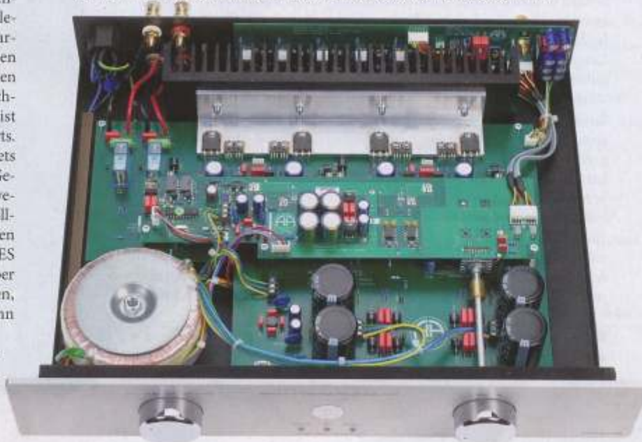
Über die roten DIP-Schalter zwischen den Phono-Eingängen werden MM- und MC-Typen vorgewählt. Das Anschlussfeld des POWER ES ist ebenso übersichtlich wie sein Innenleben, dessen hinteren Teil der Kühlkörper für die vier Endtransistoren samt Treibern einnimmt
