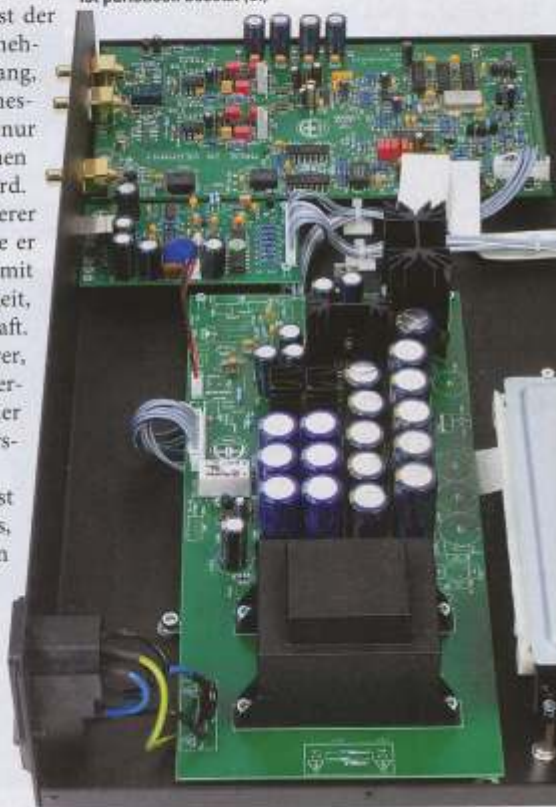
Das mit vier stabilen Spannungsversorgungen bestückte Netzteil-Board des Players zeigt den Aufwand. Sein Anschlussfeld ist puristisch besetzt (o.)
